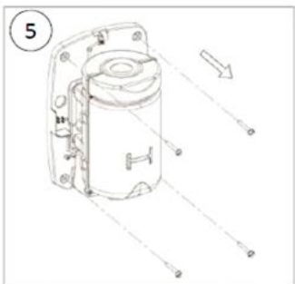
5 Desapertar os parafusos de montagem na parede (x4).
